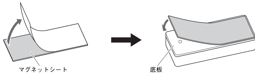
2. マグネットシートを貼ったアンテナケースをスチールの壁面に取り付ける。
