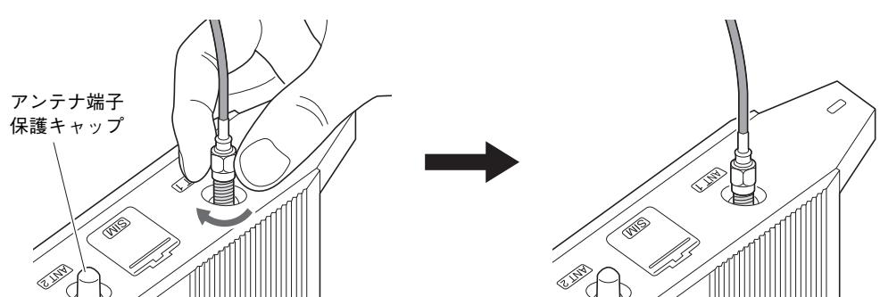
**注記** プライヤーなどの工具は使用しないでください。アンテナケーブルまたはアンテナ端子が破損する危険があります。
