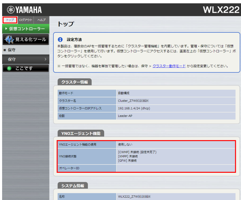
APのWeb GUI [トップ]（YNOエージェント機能は使用しない）
