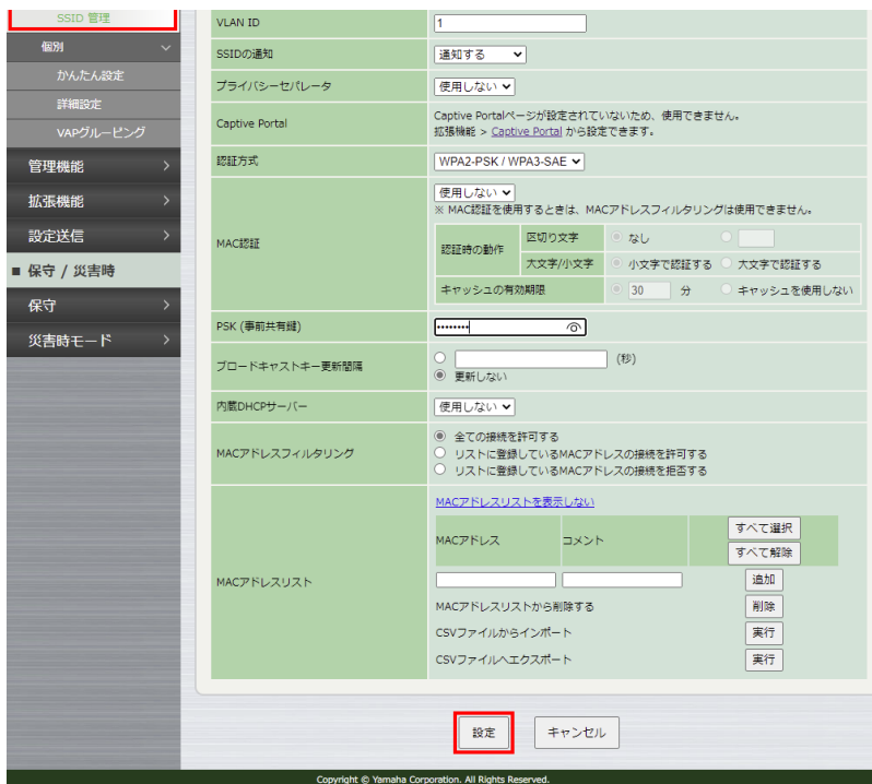
仮想コントローラーのWeb GUI [無線設定] – [SSID管理] – [VAP1設定]（最下の [設定] ボタン）
