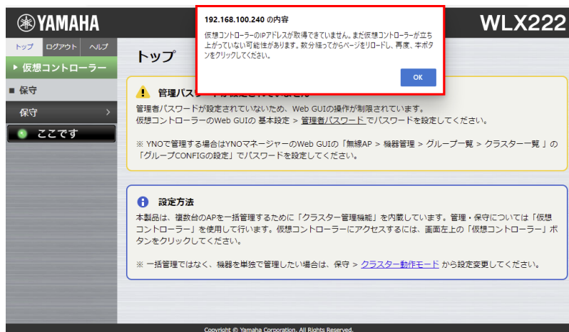
APのWeb GUI [トップ]（仮想コントローラーが起動中の場合の注意表示）
