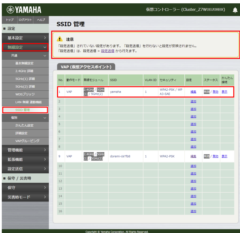
仮想コントローラーのWeb GUI [無線設定] – [SSID管理]（VAP1を設定後、設定送信を行う）
