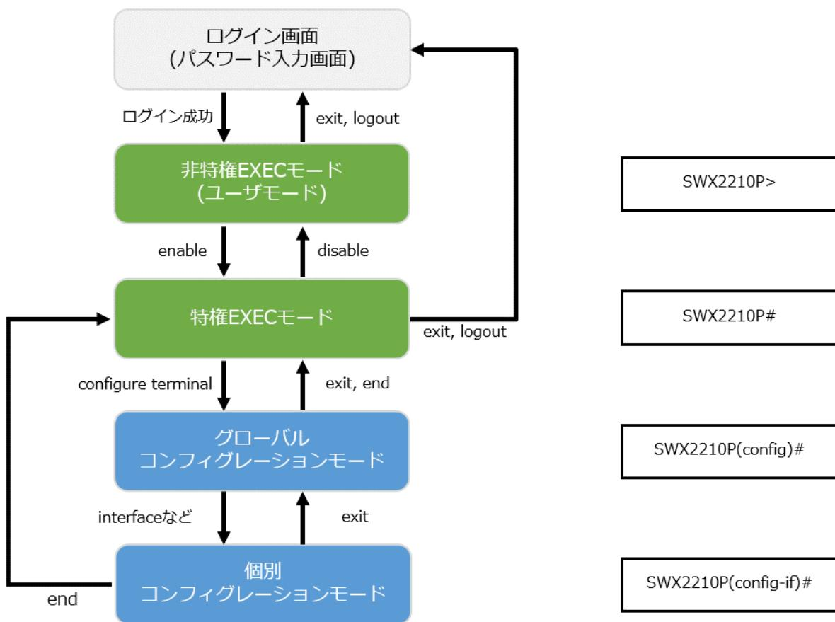
コマンド入力モードの遷移に関する基本的なコマンドは、以下となります。グローバルコンフィグレーションモードから個別コンフィグレーションモードへの遷移コマンドについては、「個別コンフィグレーションモード」を参照してください。
