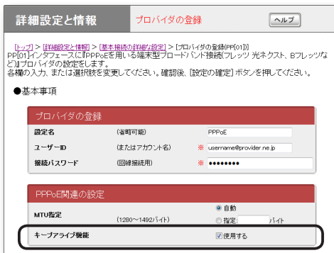
「PPPoEを用いる端末型ブロードバンド接続（フレッツ光ネクスト、Bフレッツなど）」接続の設定画面の例
